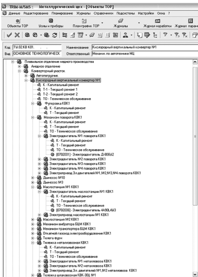
Рис. 1. Структура основных фондов в виде иерархического дерева
