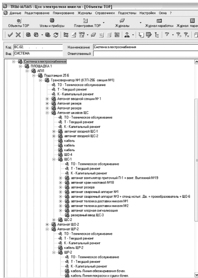
Рис. 2. Структура основных фондов в виде цепочки подключения
