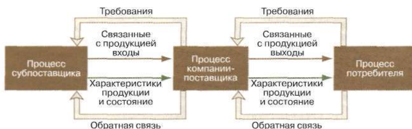
Схема 1 Взаимосвязь процессов (с потоками и информацией) в цепочке поставки
