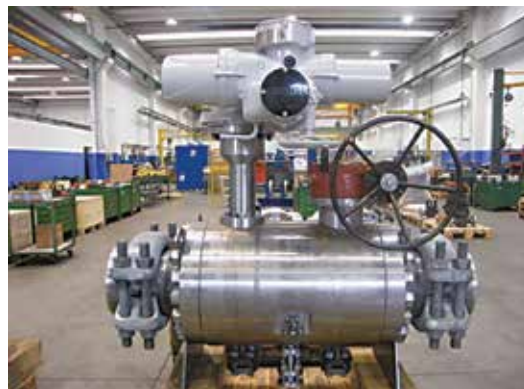
Рисунок 1 – Шаровой кран повышенной надежности с дублирующим затворным блоком (компания BFE)
